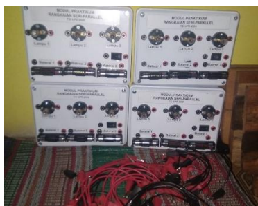
Gambar 2. Media Trainer Rangkaian Listrik Seri dan Paralel
