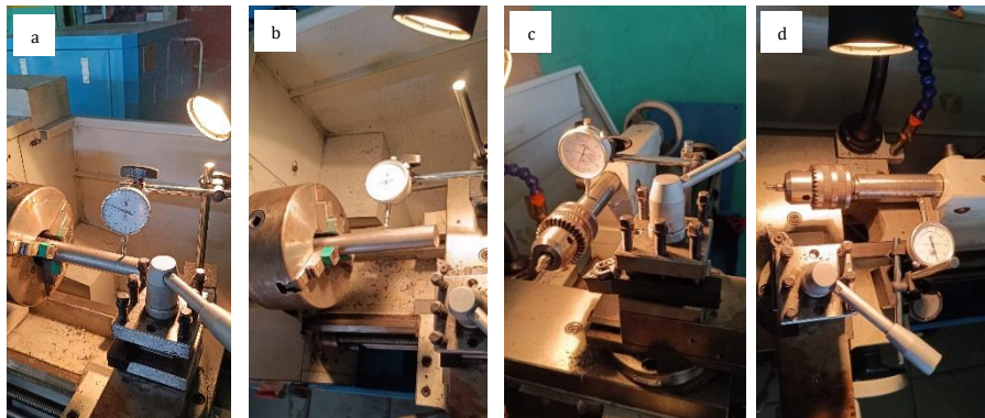
Gambar 3. Pengujian Geometris Mesin Bubut, a) uji spindle arah vertikal, b) uji spindle arah horisontal, c) uji tailstock arah vertikal, d) tailstock arah horisontal
