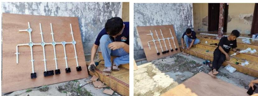
Gambar 1. Pembuatan *Trainer* Instalasi Listrik
